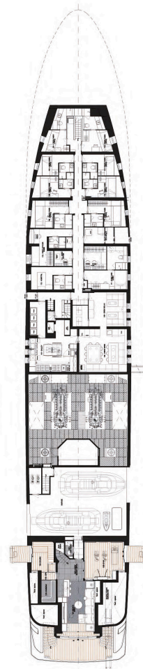
Cubierta inferior El garaje central acomoda dos auxiliares de 7,5m, mientras que la mayoría de Toys se almacenan en los garajes laterales.
